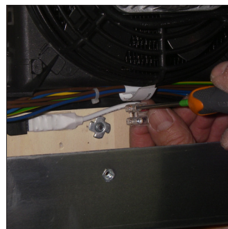
F4. Trennen Sie die Netzkabel und den Led Rezeptor
