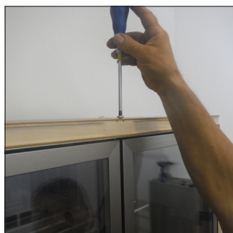
B1. Lösen Sie die obere Schraube auf dem Deckel der Vitrine
