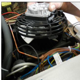
L2. Entfernen Sie den Lüfter, indem Sie ihn gegen den Uhrzeigersinn drehen
