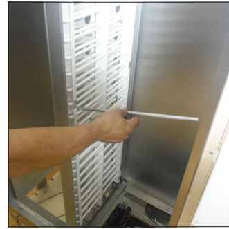
C3. Nachdem Sie alle Kunststoffclips entfernt haben, nehmen Sie alle Aluminium Stangen (Flaschenhalter) aus der Rechten Seite der Vitrine heraus
