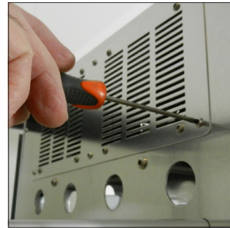
I3. Ersetzen Sie die Lüfter, wieder zuschrauben und die Verkleidungswand wieder anbringen
