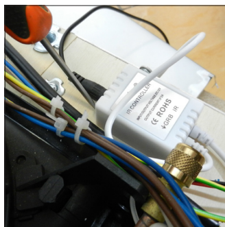
F1. Lösen Sie die Schrauben, die den Rezeptor (Controller) an der Wanne sichern
