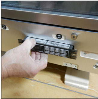
H1. Nachdem Sie den Thermoregler entfernt haben, lösen Sie bitte die Sonde von der Klemmsicherung
