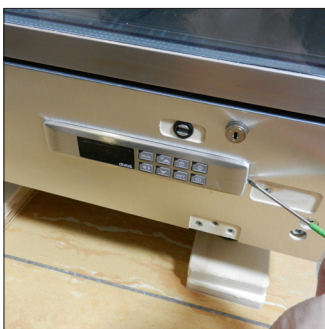
G1. Entfernen Sie die Metall-Verkleidung durch aushacken der seitlichen Federn (benützen Sie dafür einen kleinen Schraubendreher)
