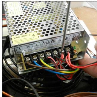
D2. Lösen Sie das Netzteil von den Kabeln
