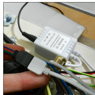
F3. Positionieren Sie den neuen Rezeptor, schliessen Sie Netzanschluss und Led wieder an
