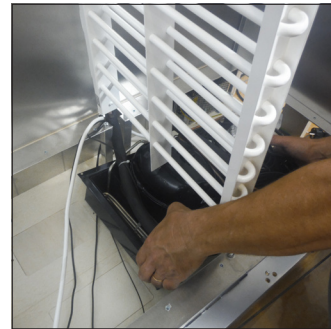
C6. Lösen Sie die Schrauben, die die Kühlanlage an der Basis sichern und entfernen Sie die Kühlanlage
