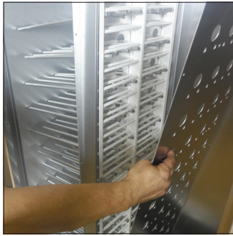
C1. Alle Aluminium Flaschenhalter nach Links verschieben oder abschrauben (je nach Modell)
