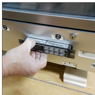
G2. Lösen Sie die Schrauben, entfernen Sie den Thermoregler indem Sie die Kabel trennen
