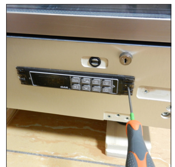
G4. Metall-Verkleidung wieder aufsetzen, erst die eine dann die andere seitliche Feder einhacken
