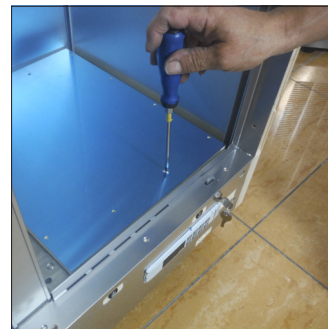
A4. Entfernen Sie die zugrunde liegenden Verschlusskappen indem Sie die Schrauben lösen.
