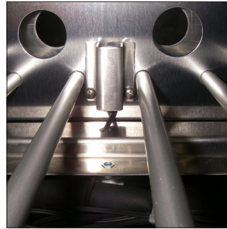
H3. Befestigen Sie die Sonde und Schutzabdeckung, bitte führen Sie den Kabel durch das vorgesehene Loch im unteren Träger
