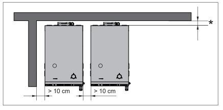
\*Maintenir une distance postérieure suffisante afin que l'étiquette de la borne equipotentiale soit visible facilement quand l'appareil est installé. La même borne doit être accessible pour l'installation du câble equipotential quand le four a été installé selon les instructions indi qués. Placer l'appareil de façon à permettre l'accès du côté droit pour les opérations d'installation, entretien et assistance technique.
