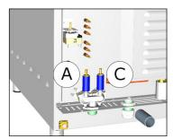
Dans les modèles a 4 et 7 bacs, l'électrovalve (A) alimente le production de vapeur en mode mixte te en mode vapeur et la (C) le système de condensation de la vapeur.
