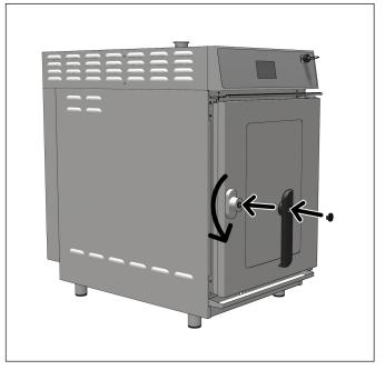
Retirer la poignée et mettez-la à l'envers. Visser la vis de fixation circulaire de la poignée et mettre le couvercle circulaire dans sa position.
