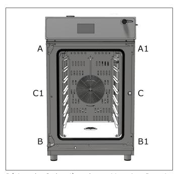
Dévisser les 2 charnières des positions A et B et visser-les sur les trous predisposés dans les positions A1 et B1.
