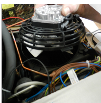
L2. Retirez le ventilateur en tournant dans le sens antihoraire
