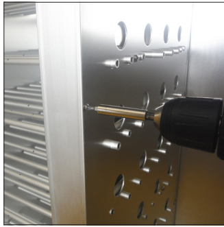
C2. Desserrez toutes les vis et enlevez le panneau central du côté droit
