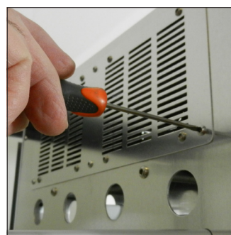
I3. Rébranchez le ventilateur, vissez-le et remplacez le couvercle
