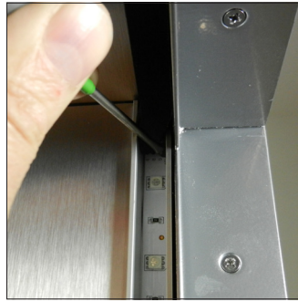
E6. Retirez les bandes LED défectueuses des rails à l'aide d'un tournevis
