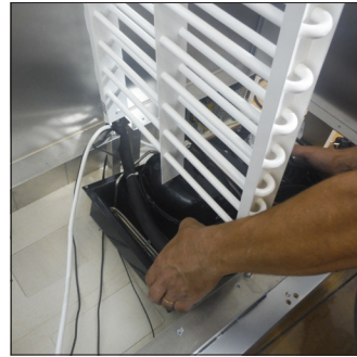
C6. Retirez les vis qui fixent le système de refroidissement et retirez-le
