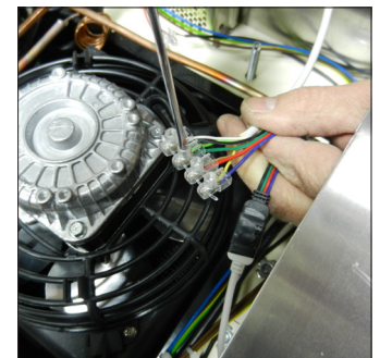
E4. Connectez les câbles des LED au recepteur comme ils étaient avant en respectant la couleur
