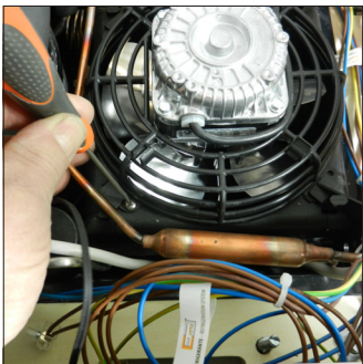
L1. Dévissez la vis sur la grille du ventilateur
