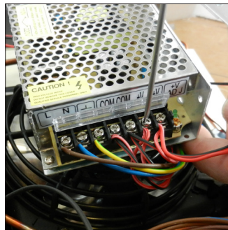
D2. Dèconnecter l'alimentateur du câblage
