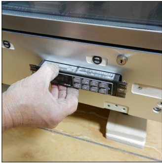
H1. Après avoir retiré le thermoregulateur déconnecter la sonde du bornier
