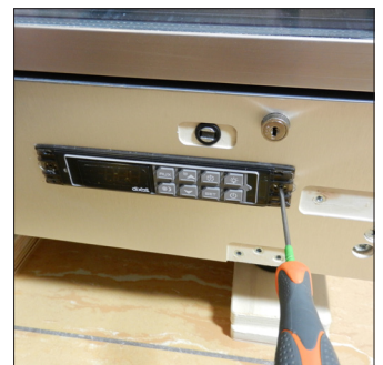
G4. Révisser les nouveau thermoregulateur et appliquez la couverture avec le ressort avant l'autre
