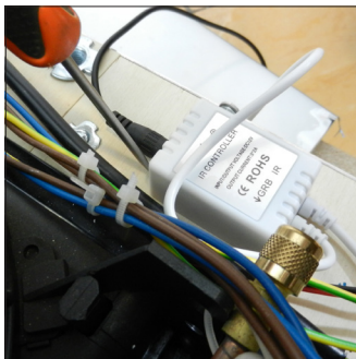
F1. Dévisser les vis qui fixent le récepteur à la cuve
