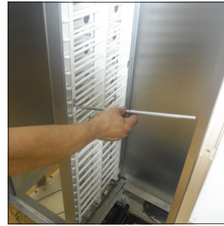
C3. Après avoir enlevé toutes les clips en plastique des tiges il faut les extraire par la partie droite
