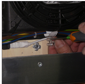
F4. Débranchez les câbles d'alimentation et le connecteur des leds
