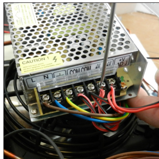
D2. Dèconnecter l'alimentateur du câblage
