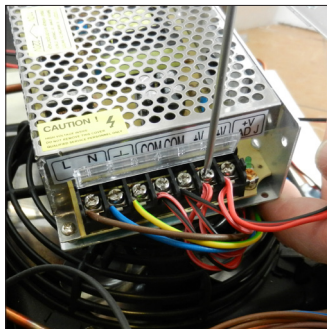
D2. Dèconnecter l'alimentateur du câblage
