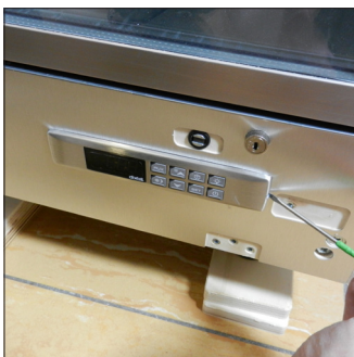
G1. Dévisser la couverture en metal en appuyant d'abord sur le ressort de gauche (utiliser un petit tournevis)
