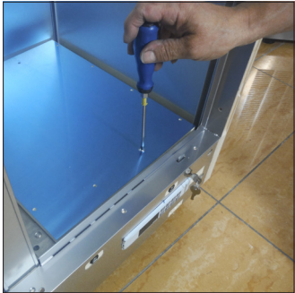
A4. Retirez le bouchon de fermeture en dévissant ses vis
