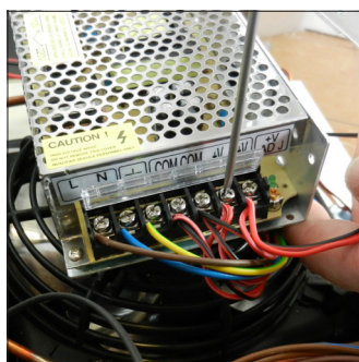
E5. Scollegare le strisce led guaste dall'Alimentatore
