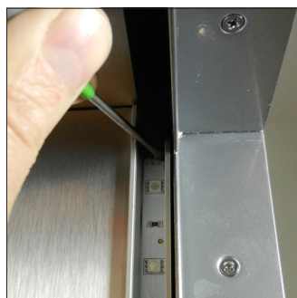
E2. Rimuovere le strisce LED guaste dalle guide aiutandosi con un cacciavite
