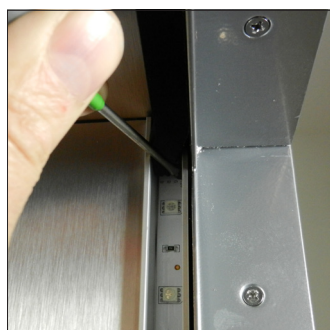
E6. Rimuovere le strisce LED guaste aiutandosi con un cacciavite
