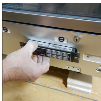
G2. Svitare, estrarre il termoregolatore e scollegare i cavi
