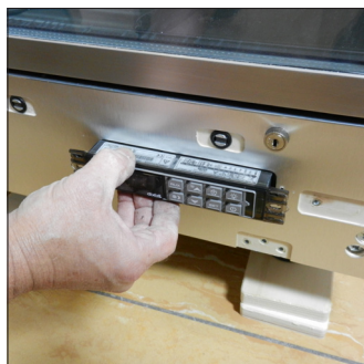
H1. Dopo aver estratto il termoregolatore scollegare la sonda dalla morsettiera
