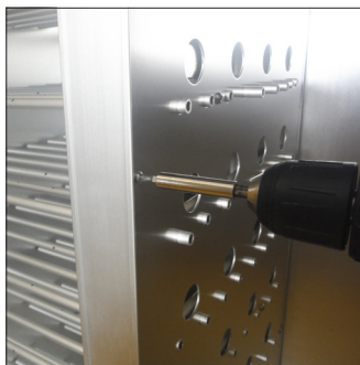
C2. Svitare tutti i bulloni e rimuovere il pannello di alluminio centrale lato destro
