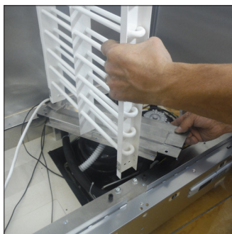
C5. Estrarre la traversa in alluminio
