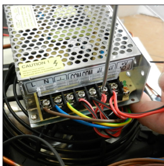
D2. Scollegare l'alimentatore dal cablaggio
