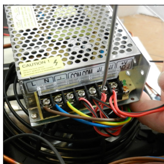
E5. Scollegare le strisce led guaste dall'Alimentatore
