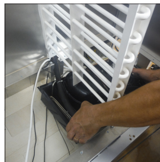
C6. Svitare le viti che lo fissano alla base ed estrarre l'impianto di refrigerazione
