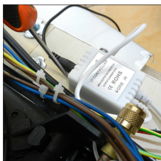
F1. Svitare le viti che fissano il controller alla vasca
