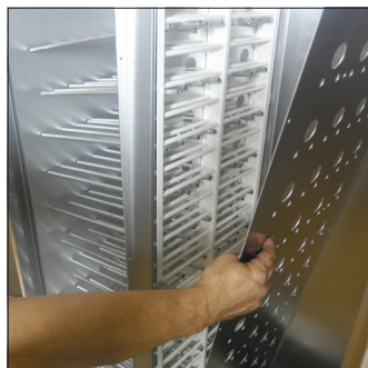
C1. Spostare tutti i tondini in alluminio verso sinistra oppure svitarli (dipende dai modelli)
