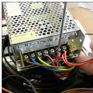
E5. Scollegare le strisce led guaste dall'Alimentatore
