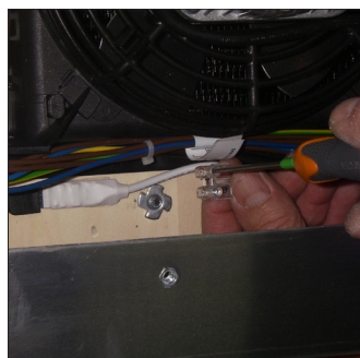
F4. Scollegare i cavi dell'alimentazione ed il connettore dei led
