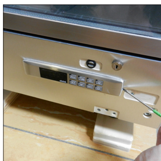
G1. Estrarre la cover metallica sganciando le molle laterali (utilizzare un cacciavite piccolo a taglio)
