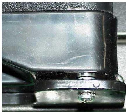
Fotografia 1 – Parafuso de fixação da mola da porta
