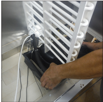
C6. Quitar los tornillos que fijan el sistema refrigerador a la base de la vitrina y extraer el sistema refrigerador
