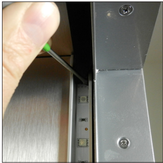
E2. Retirar las tiras de LED fallidos con ayuda de un destornillador
