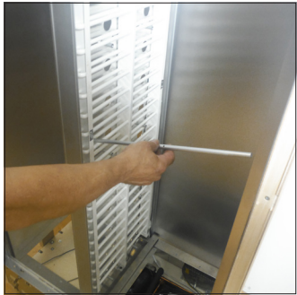
C3. Después de quitar todos los clips de plástico, extraer todas las barras de aluminio de la parte derecha de la vitrina
