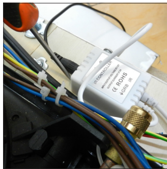
F1. Quitar los tornillos que fijan el receptor al contenedor
