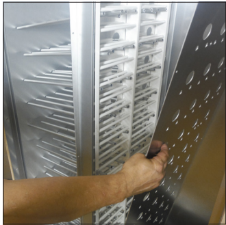
C1. Mover todas las barras de aluminio a la izquierda, o destornillar (según el modelo)
