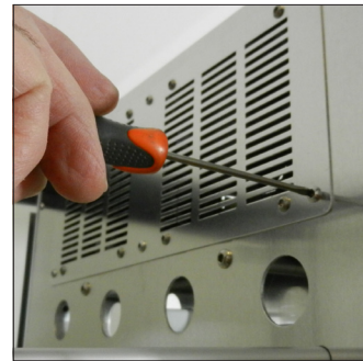
I3. Volver a conectar y apretar los ventiladores, montar la tapa
