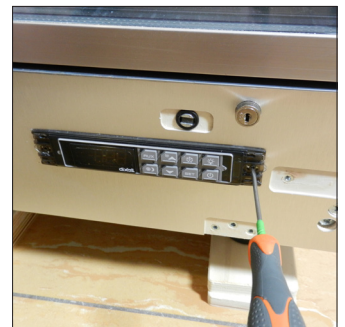
G4. Instalar el nuevo controlador y aplicar la tapa metálica insertando primero un muelle lateral y luego el otro
