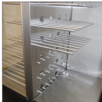
A2. Mover a la izquierda, 3 filas de barras en aluminio o destornillar ellos (según el modelo)
