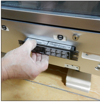
H1. Despu s de retirar el controlador desconectar la sonda desde el terminal
