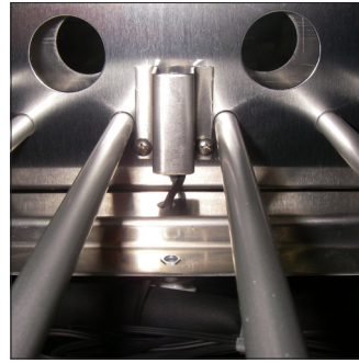
H3. Volver a colocar la sonda y la tapa de protección haciendo pasar el cable desde la abertura provista en el soporte inferior
