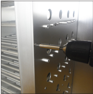
C2. Aflojar todos los tornillos y retirar el panel central de aluminio lado derecho
