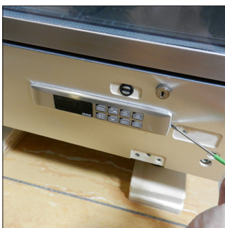
G1. Extraer la tapa metálica desenganchando los muelles (utilizar un destornillador pequeño)
