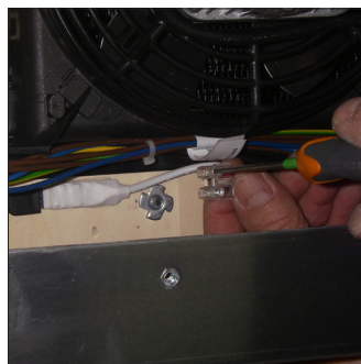
F4. Desconectar los cables de alimentación y el conector de los leds
