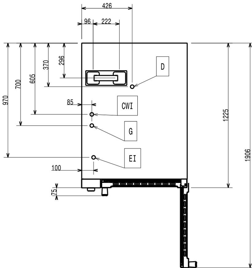
Modèle au GAZ 20 GN 1/1 - Schéma d'installation (597405W00)
