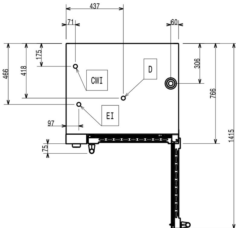
**Modèle ÉLECTRIQUE 10 GN 1/1 - Schéma d'installation (597405Z00)**
