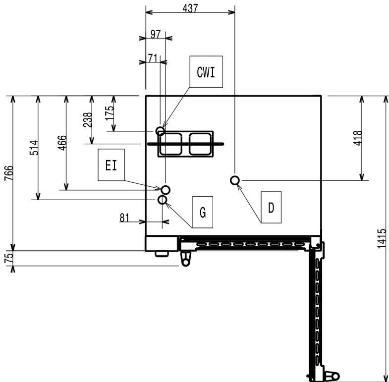
**Modèle au GAZ 10 GN 1/1 - Schéma d'installation
