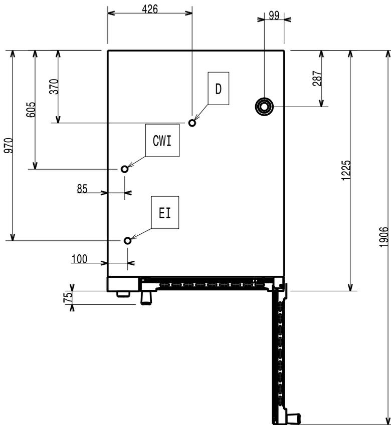
**Modèle ÉLECTRIQUE 20 GN 1/1 - Schéma d'installation (597406100)**
