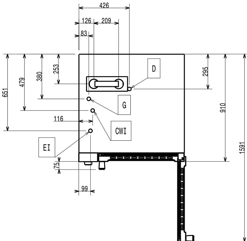
**Modèle au GAZ 10 GN 2/1– Schéma d'installation (597405V00)**
