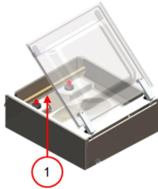
Abbildung 13: Schweißbleiste entfernen
