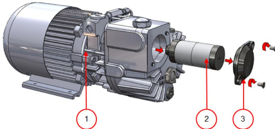
Abbildung 11: Austausch des Ölnebelfilters (Pumpe 8 m<sup>3</sup>/Std.)
