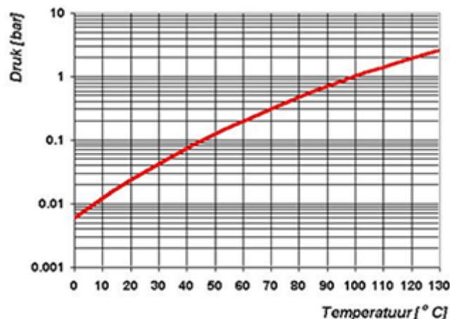
Abbildung 9: Dampfdruckkurve von Wasser
