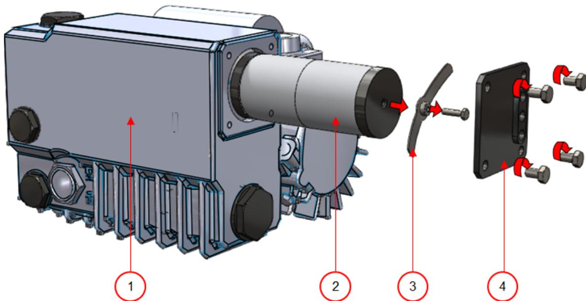
Abbildung 12: Austausch des Ölnebelfilters (Pumpe 16 m<sup>3</sup>/Std. / 21 m<sup>3</sup>/Std.)
