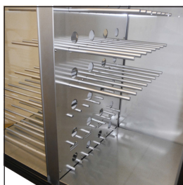
A2 . 3 Ebene der Aluminium Halter nach Links verschieben oder abschrauben (je nach Modell)
