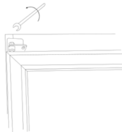
8. Den Stift vom oberen Scharnier spannen.
