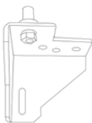
10. Den Stift vom unteren Scharnier wieder auf dem gedrehten Scharnier montieren.
