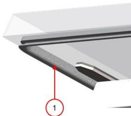
Schéma 8: Remplacement du joint du couvercle
