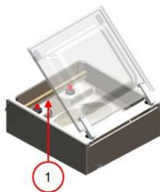
Schéma 5: Retrait de la barre de soudure
