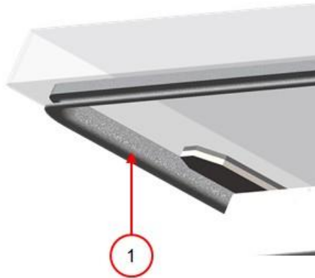
Schéma 8: Remplacement du joint du couvercle
