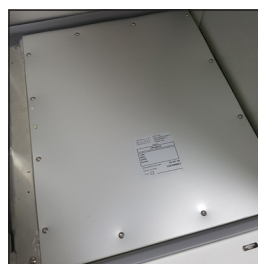
A4 . Retirez le couvercle de fermeture en dévissant ses vis
