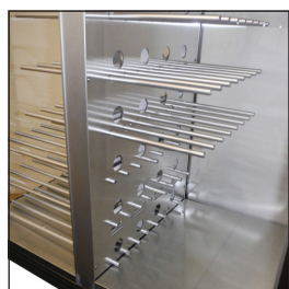
A2 . Faire glisser vers la gauche 3 files en bas de tiges ou les dévisser (selon le modèle)
