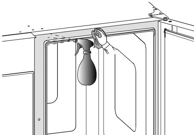
4. Avec la porte ouverte, appuyer sur les deux clips de fixation supérieur et inférieur, comme illustré ;
