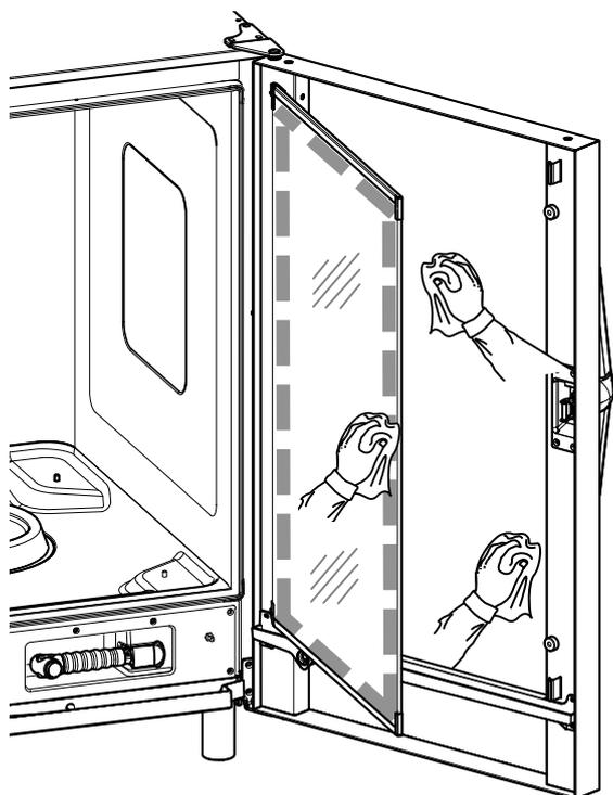
6. Remettre la vitre intérieure en place dans les clips et fermer la porte du four.
