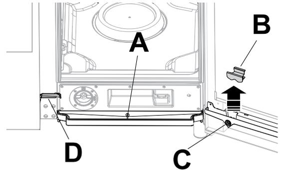
3. Reinigen Sie die kleine Rinne ("D") regelmäßig mit der dem Gerät beiliegenden Bürste.
