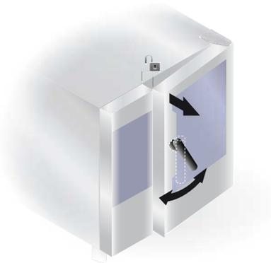
1. Drehen Sie den Türgriff bis zum Anschlag im Uhrzeigersinn oder gegen den Uhrzeigersinn, um die Ofentür komplett zu öffnen. Das gerade ausgeführte Garprogramm wird unterbrochen.
