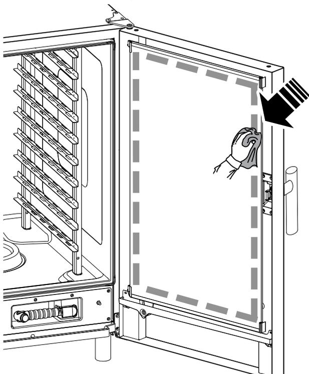
2. Drücken Sie bei geöffneter Tür auf die zwei oberen und unteren Sicherungsclips (siehe Abbildung), um auf den Zwischenraum zwischen Innen- und Außenscheibe zugreifen zu können.
