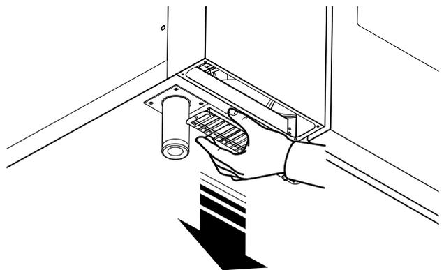
3. Trocknen Sie den Filter anschließend und setzen Sie ihn wieder in die Halterung ein.
