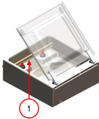
Figura 18: Extracción de la barra de sellado (tapa de plástico)
