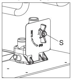
**ACHTUNG!** Führen Sie diese Arbeit nur nach dem Abkühlen des Gerätes aus (die Restwärme der Heizung kann auch nach dem Abschalten das entleerte Becken beschädigen). Sollte dies nicht möglich sein, lassen Sie beim Ablaufen des Kochwassers gleichzeitig Kaltwasser in das Becken laufen.
