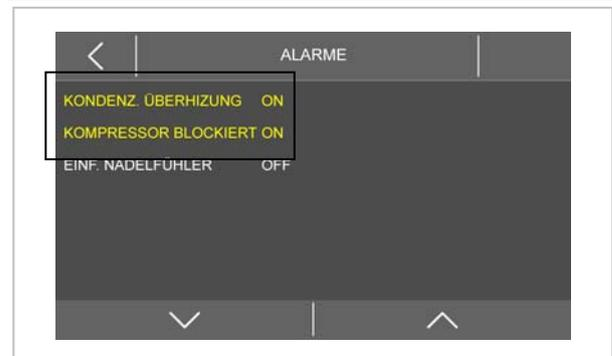
Sollten Umgebungsbedingungen oder Funktionsstörungen zum Überschreiten der Max. Temperatur im Verdampfer führen, schreitet der Alarm ein und blockiert die Funktion des Gerätes. Sobald wieder ein akzeptabler Temperaturwert erreicht wird, kann die Maschine erneut in Betrieb genommen werden.
