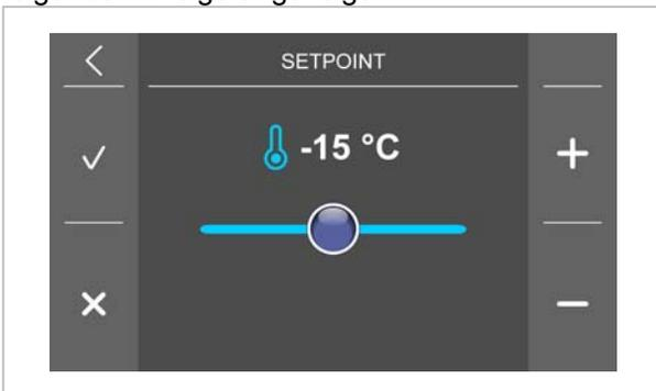
Das Drücken des Bereich **+** und **-** ermöglicht die Einstellung der Temperatur.
