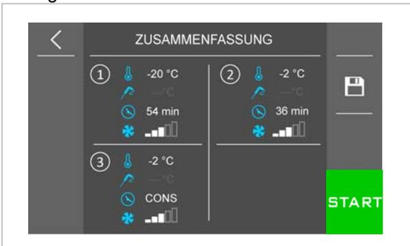
Um die einzelnen Werte der Phasen zu ändern, auf dem entsprechenden Bereich drücken.
