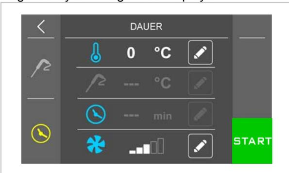
Das Drücken des Bereichs 0 °C ermöglicht die Änderung der Betriebstemperatur der Zelle.
