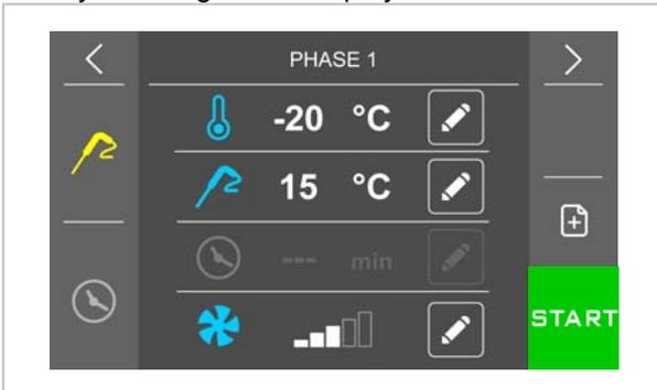
Man kann von der Fühlerphase auf die temperaturgesteuerte Phase umspringen und die entsprechenden Setpoint einstellen.
