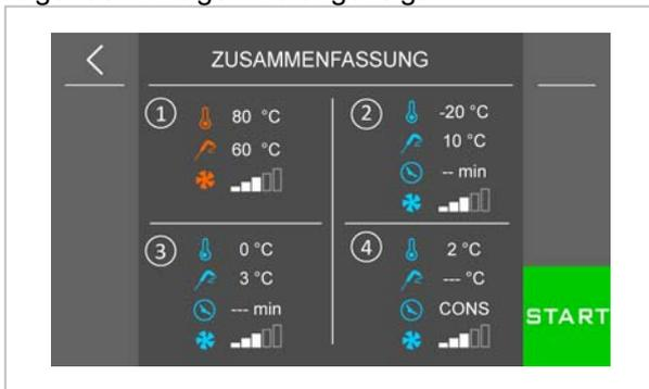
Um die einzelne Werte der Phasen zu ändern, auf dem entsprechenden Bereich drücken. Z.B., um die Zellentemperatur während der Phase des langsamen Kochens zu ändern, auf dem Bereich Phase 1 drücken; das Bildschirm der erste Phase wird angezeigt.
