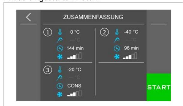
Aus diesem Bildschirm können Sie die Ausführung des Rezepts starten, oder den Sollwert des Programms ändern, indem Sie auf dem Bereich der entsprechenden Phase drücken. Nach der Änderung der Daten, können Sie folgende Optionen wählen:
