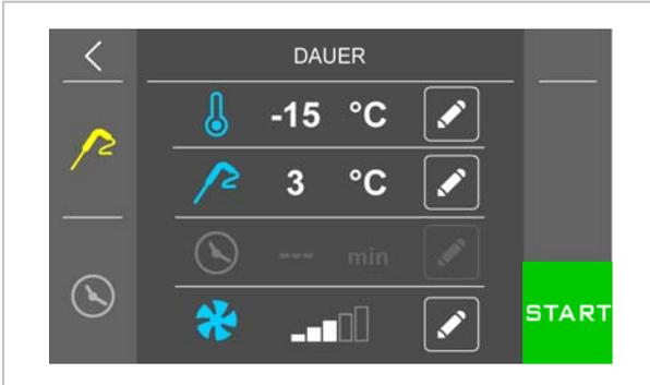
Das Drücken des Bereichs -15 °C ermöglicht die Änderung der Betriebstemperatur der Zelle.
