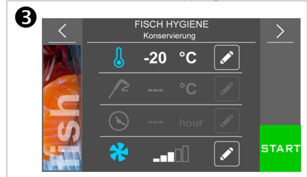
Das Drücken des Bereichs -20 °C ermöglicht die Änderung der Zelltemperatur während der Konservierungsphase.
