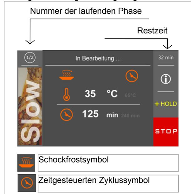
Beim drücken auf dem Bereich **i** kann man die von den Fühler gelesene Temperatur, der Stand der Ein- und Ausgänge und die vom System gespeicherten Fehlermeldungen aufrufen.
