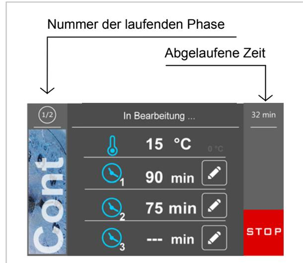
Der Zyklus startet durch Betätigung den ersten Zeitmesser, es besteht die Möglichkeit, bis zu drei separate Timer einzurichten. Die Timer können beim laufenden Zyklus durch Drücken der Bleistift-Bereich zeitlich eingestellt werden.
