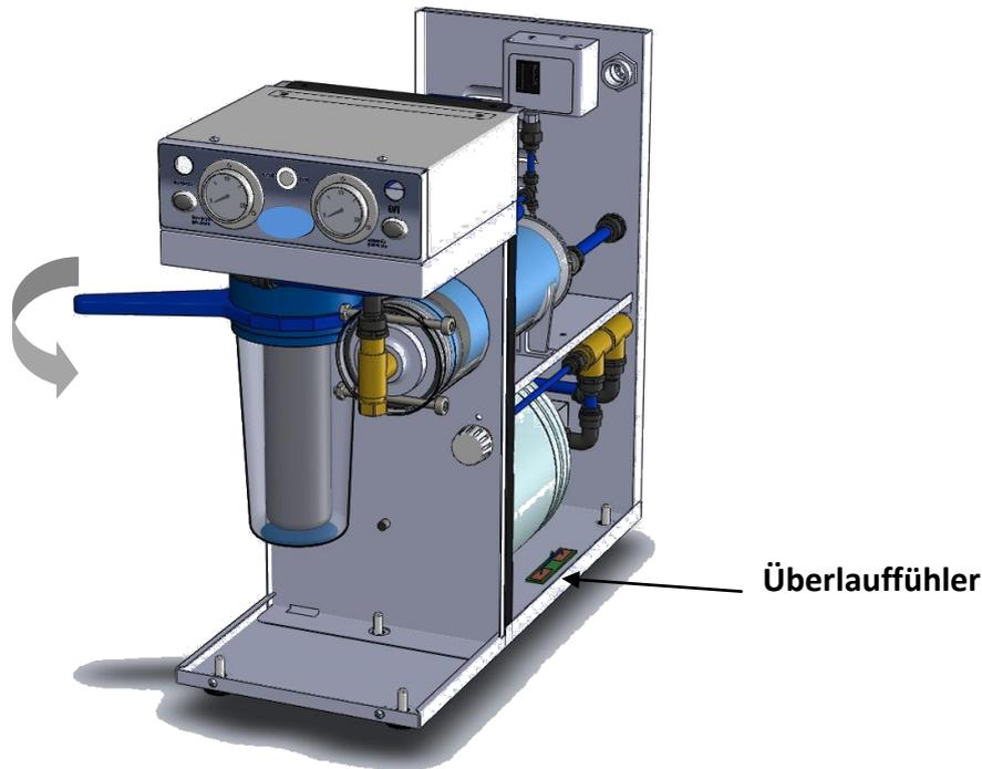
Setzen Sie den neuen Filter ein und stellen Sie sicher, dass keine Lecks vorhanden sind.
