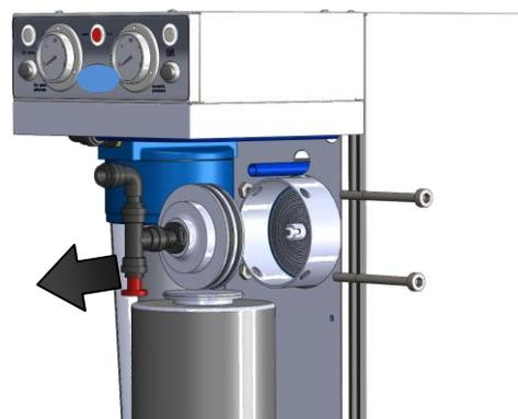
Entfernen Sie die alte Membran aus dem Gefäß, besser mit einer Zange, und ziehen Sie sie auf sich zu.
