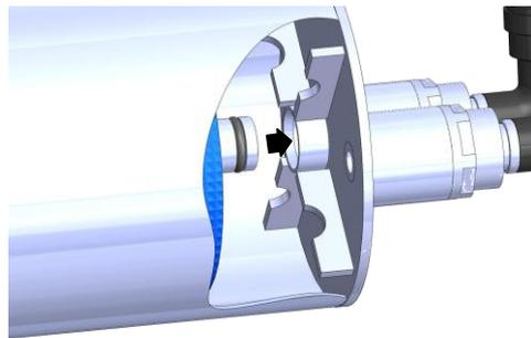
Wechseln Sie den O-Ring aus, fetten Sie ihn und setzen Sie ihn in den Boden des Gefäßes ein.
