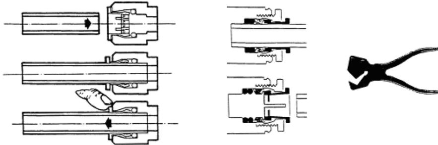
Auf der Abbildung werden die Arbeiten für das Anschließen und Abklemmen sowie die entsprechenden technischen Details angegeben. Die Leitungen müssen einen angemessenen Durchmesser aufweisen und auf die passende Länge geschnitten werden; ein perfekter Schnitt führt zu einer guten Haftung im Inneren der Schnellkupplung.
