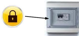
Stellen Sie sicher, dass sich die Taste Bypass in der geschlossenen Position befindet.
