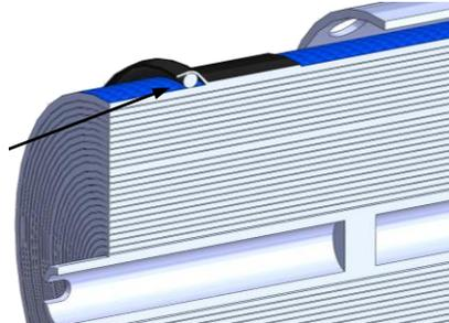
Setzen Sie die Membran vorsichtig in den Sitz ein und achten Sie dabei darauf, dass der O-Ring nicht beschädigt wird.
