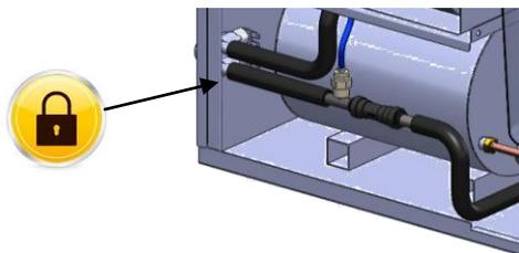
Schließen Sie den Hauptwasserhahn, der der Anlage vorgeschaltet ist.
