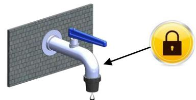
Halten Sie einen Behälter zum Auffangen des noch enthaltenen Wassers bereit. **ACHTUNG!** Das Wasser kann zu Beginn mit einem Druck von 3-4 bar austreten.
