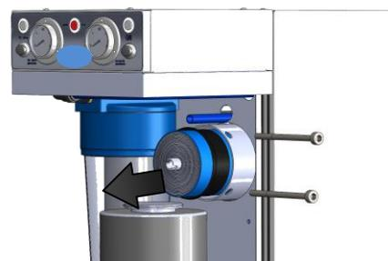
Achtung! Entfernen Sie den O-Ring unter der Lippendichtung der alten Membran und setzen Sie die neue Membran in diese Position ein, wieder auf der folgenden Abbildung gezeigt.
