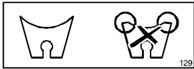
Sicherstellen, daß die Schabekonturen aus Plastik an den Kufen weder verkratzt noch deformiert sind und die Seitenkufen keine Zeichen von Abnutzung aufweisen (s. Abb.), falls doch, ersetzen Sie sie bitte.
