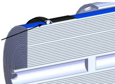
Introduzca la membrana con cuidado prestando atención a no dañar la junta tórica ubicada en el apéndice de la membrana.
