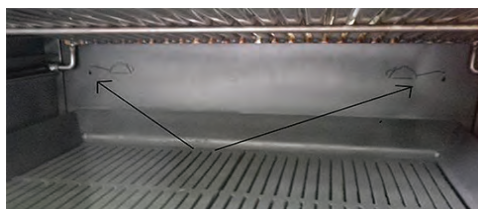
Points de graissage intérieurs du système de levage
