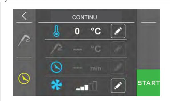
Une pression sur la région
