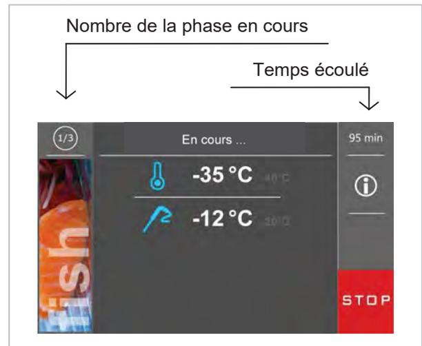
En appuyant sur la région on peut voir la température lue par les différentes sondes, l'état des entrées / sorties et les alarmes stockées par le système. Pour arrêter le cycle en cours appuyer
