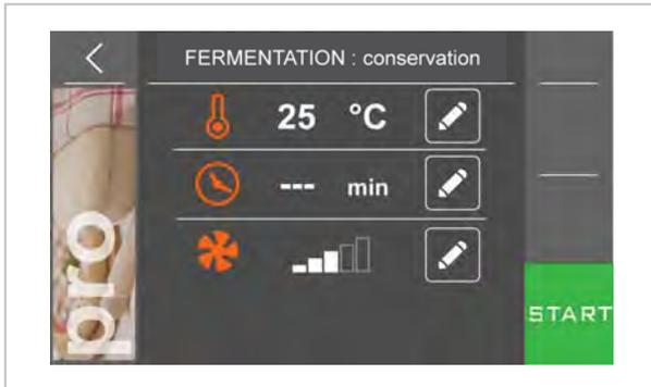
Une pression sur la région
