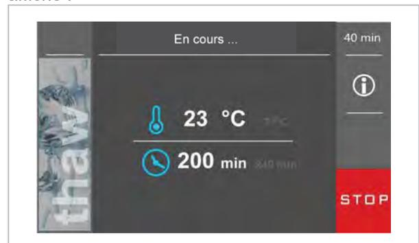
En appuyant sur la région **i** on peut voir la température lue par les différentes sondes, l'état des entrées / sorties et les alarmes stockées par le système.
