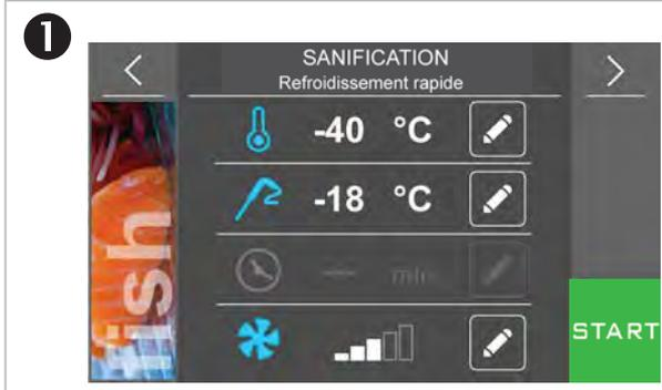
Une pression sur la région -40 °C permet de changer la température de fonctionnement de la cellule pendant le refroidissement rapide.
