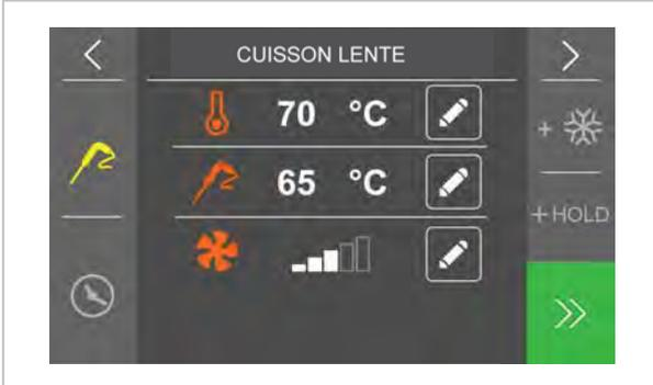
Une pression sur la région
