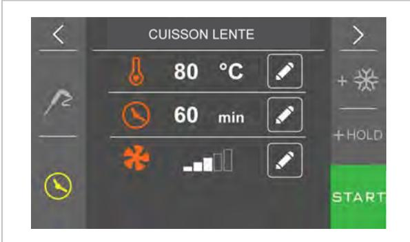
Une pression sur la région
