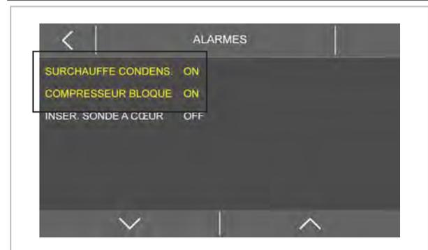
En cas de conditions environnementales ou d'anomalies fonctionnelles qui pourraient causer un dépassement de la valeur maximum de température dans le condensateur, intervient l'alarme qui bloque le fonctionnement de la machine. Une fois retournés à une valeur de température acceptable, la machine peut être mise en fonction.
