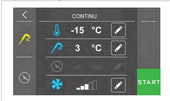
Une pression sur la région -15 °C permet de changer la température de fonctionnement de la cellule .
