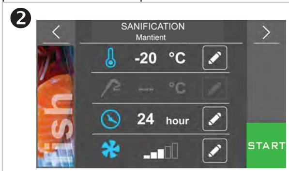
Une pression sur la région -20 °C permet de changer la température de fonctionnement de la cellule pendant la préservation.
