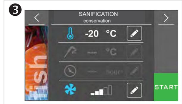
Une pression sur la région -20 °C permet de changer la température de fonctionnement de la cellule pendant la phase de conservation.
