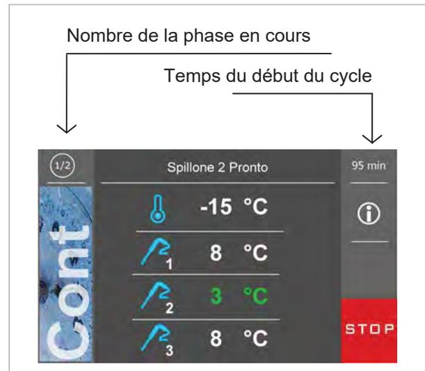
Cours de l'exécution du cycle, lorsque la porte est fermée, sera exécuté le contrôle sur la propre insertions des sondes à piquer et le cycle se termine seulement lorsque toutes les sondes insérées atteignent la température souhaitée.
