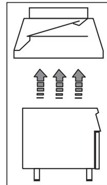
**REMARQUE !** Le système doit garantir que : a) l'évacuation des fumées ne soit pas obstruée ; b) la longueur du tuyau d'évacuation ne soit pas supérieure à 3 m. Utiliser l'adaptateur pour raccorder des conduits d'évacuation ayant un diamètre différent.
