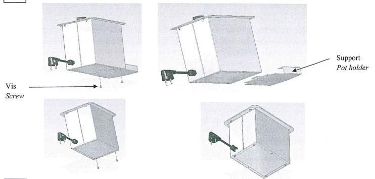
Retirer les écrous (côté opposé à l'alimention). Mettre en place un bride Warm-it puis reserrer les écrous. Retirer les écrous côté alimentation, ils seront utilisés plus tard.
