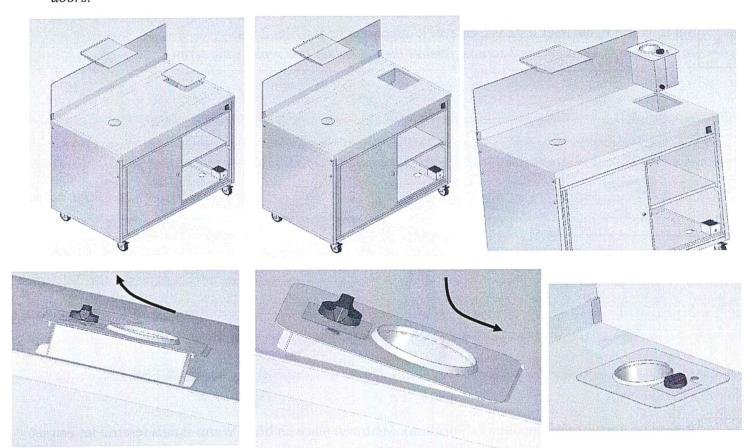
**D** Ouvrir la porte droite, fixer l'autre bride Warm it avec les 2 écrous retirés auparavant. Le Warm it est encastré.
