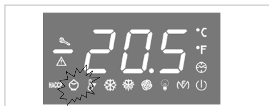
Questo LED indica l'attivazione della funzione ENERGY SAVING
