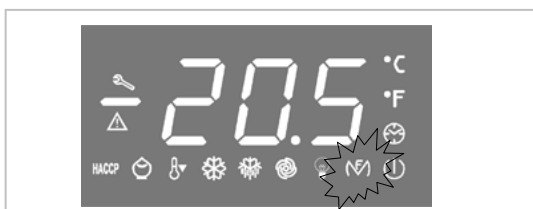
Questo LED indica lo stato (accessorio o spento) delle RESISTENZE PORTA
