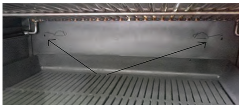
Puntos de engrase interiores del sistema de elevación
